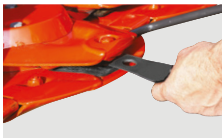
Fissaggio FAST-FIT: i coltelli possono essere sostituiti rapidamente.
