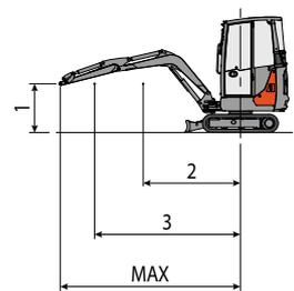
La capacità di sollevamento è basata sulla norma ISO 10567 e non eccede oltre il 75% del carico statico di ribaltamento o dell'87% della capacità di sollevamento idraulico della macchina.
