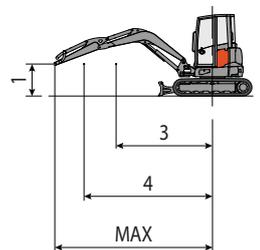
La capacità di sollevamento è basata sulla norma ISO 10567 e non eccede oltre il 75% del carico statico di ribaltamento o dell'87% della capacità di sollevamento idraulico della macchina.
