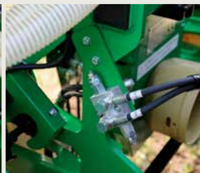
Valvola limitatrice di pressione per la trave
