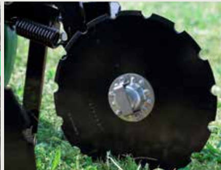
Interratore del concime a disco, montato direttamente sull'elemento di semina per una costante distanza di deposizione del concime rispetto alla posizione del seme
