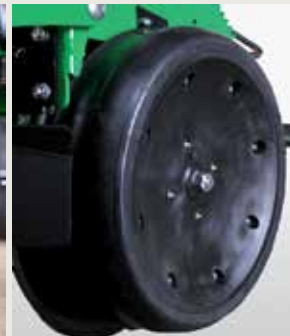
Ruote di profondità in gomma larghe 400x115 Disponibili anche in versione stretta 400x60
