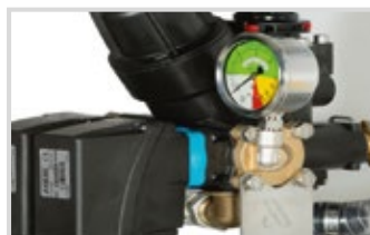
COMANDO A DISTANZA PER APERTURA E CHIUSURA ELETTRICA DALLA CABINA DEL TRATTORE ( EV2 )
