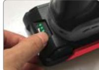
Premere il pulsante situato sul lato posteriore della forbice per visualizzare la carica della batteria.
