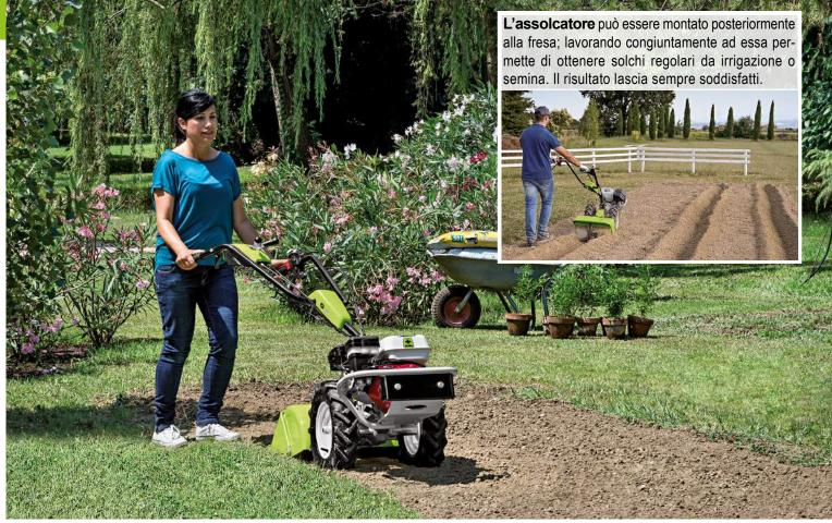
I comandi dell'avanzamento e dell'avviamento della fresa sono indipendenti. G 46 è dotato di frizione a comando attivo, un sistema che garantisce massima sicurezza e praticità. Quando la leva "presenza uomo" viene rilasciata, le ruote e la fresa si fermano immediatamente mantenendo comunque il motore in moto. La presenza di frizione con comando attivo Grillo è garanzia di assoluta sicurezza nel lavoro.
