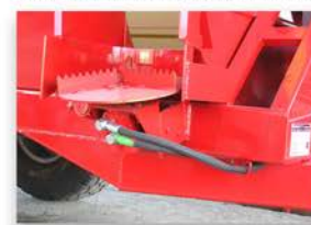
Piatto localizzatore a piede filare idraulico Lateral disc to localize manure on the row - hydraulic
