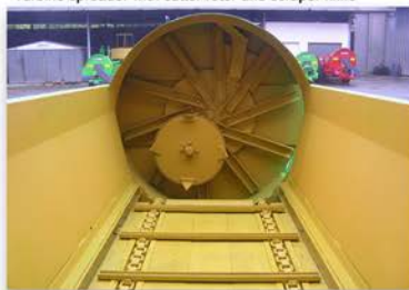
Turbina con fresa sminuzzatrice e coltello raschiatore Turbine spreader with cutter rotor and scraper knife
