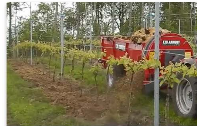
Piatto localizzatore a piede filare tipo meccanico Lateral disc to localize manure in the row - mechanic
