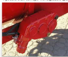
Avanzamento tappeto idraulico a velocità regolabile Hydraulic chain conveyor with adjustable speed
